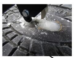
Schlagöffner - Anbauvorrichtung zum Nachrüsten für alle gängigen Unterflurhydrantenschlüssel nach DIN 3223-C
